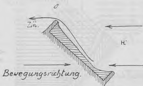
Fig. 9. Ungleichmässige Korrosion der Zinkplatte.
