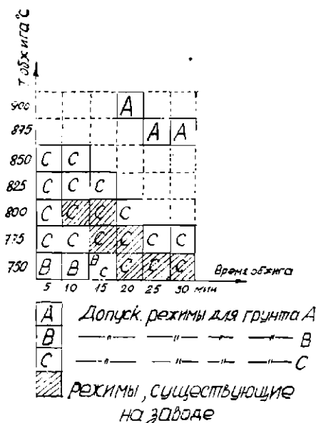
Рис. 2. Исследованные режимы обжига грунтовых эмалей
