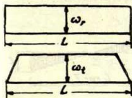
19. zīm. Taisnstūra un trapeces leņķiskā ātruma \omega maiņas veids.
