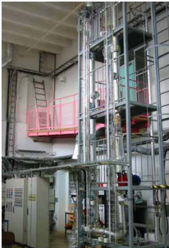
Zīm. 6. Diskveidīgais sūknis svina-bismuta vertikālajā cirkulācijas cilpā TALL termohidrauliskiem pētījumiem Stokholmas Karaliskajā Tehnoloģijas Institutā (Zviedrija).
