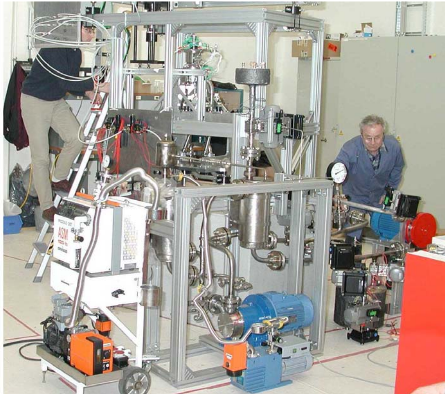
Zīm. 3. LiSoR iekārtā (PSI, Šveice), kurā tika pētītas dažādu materiālu īpašību izmaiņas šķidrā metāla plūsmā radiācijas ietekmē [4].
