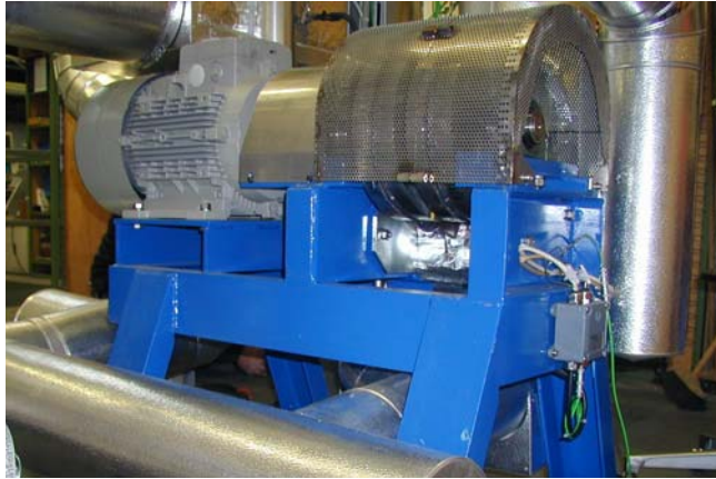
Zīm. 4. Dubults (divu pāru disku) sūknis uzstādīts šķidrā metāla (Pb-Bi) divu cilpu circulācijas iekārtā (PSI, Šveice) termohidrauliskiem pētījumiem neitronu atskaldīšanas mērķu modeļos.
