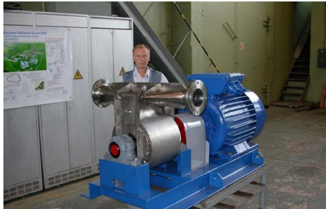
Zīm. 10. Jaudīgs indukcijas sūknis uz pastāvīgiem magnētiem dzīvsudrabam. Spiediens 6 atm., caurtece 13 L/s (170 kg/s), sūkņa piedziņas motora jauda 90 kW.
