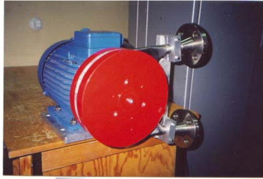
Zīm. 2. Disku tipa MHD indukcijas sūkņi uz pastāvīgiem magnētiem svina-bismuta sakausējuma pārsūkņēšanai pie temperatūras 400^{\circ}\text{C} . Maksimālais attīstāmais spiediens P = 1,7 atmosfēras, caurtece Q = 1.0 litrs sekundē (jeb 3.6 \text{ m}^3 stundā). Sūkņa piedziņas elektriskā motora jauda 5.0 \text{ kW} , lietderības koeficients 10 \% . Sūkņi uzstādīti 2001. gadā šķidrā metāla iekārtā LiSoR (PSI, Šveice).
