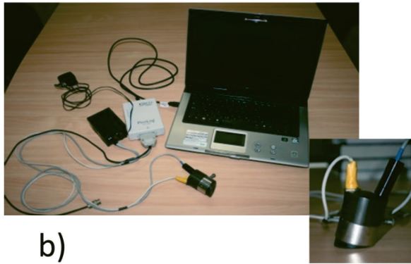
2.2. att. a) shematiski attēlota mērījumu ierīce; b) prototipa ierīces izskats.
