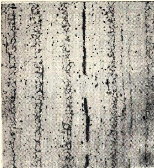
41. att. Ķentes zobena smailis (31. attēls — 7) griezuma mikrostruktūra; palielin. 100×
