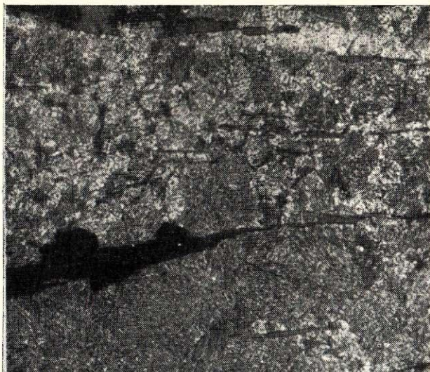
16. att. Gailišu uznavas cirvja (15. attēls — 2) griezuma mikrostruktūra; palielin. 100×
