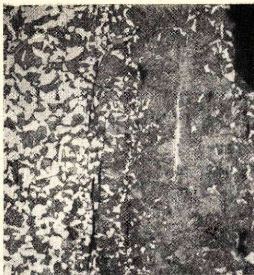
149. att. Rīgas zobena (145. attēls) smailes griezuma mikrostruktūra pēc atkvēlināšanas; palielin. 100 ×.
