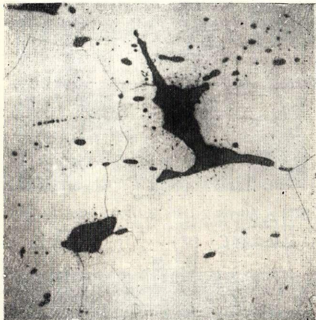
120. att. Asotes cirvja kāta daļas mikrostruktūra; palielin. 100 X.
