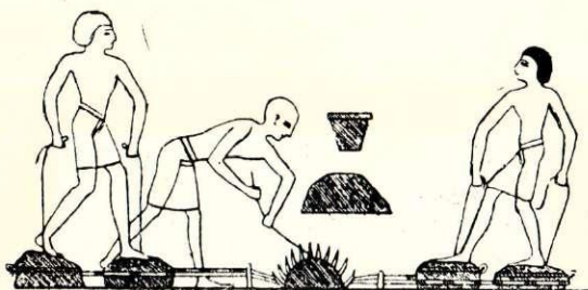
160. att. Gaisa iepūšana krāsnī ar kāju plēšām senajā Ēģiptē (1450. g. pr. m. ē.) (Stahl und Eisen, 1907, 1655. lpp.).
