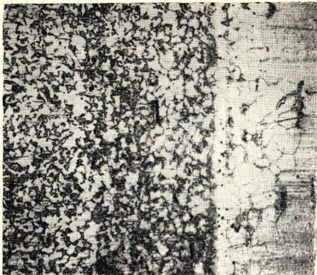
114. att. Asotes naža asmens (113. attēls — 5) mikrostruktūra divu slāņu sametinājuma vietā; palielin. 100 ×.
