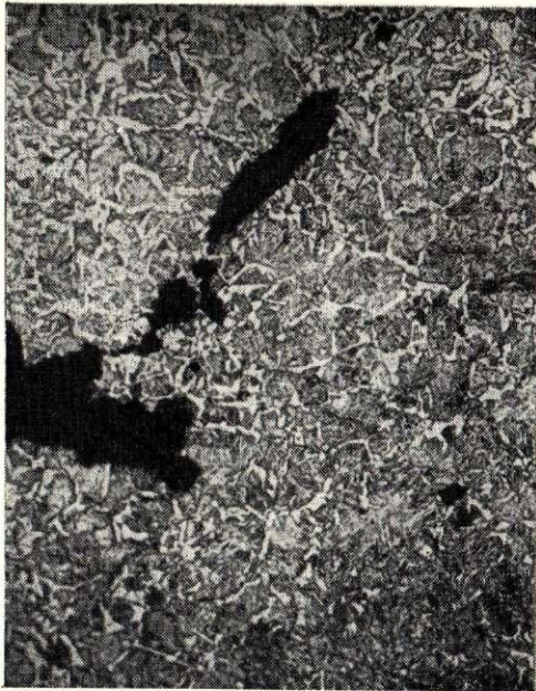
28. att. Kokmuižas cirvja fragmenta (26. attēls) kāta daļas griezuma b—b mikrostruktūra; palielin. 100×
