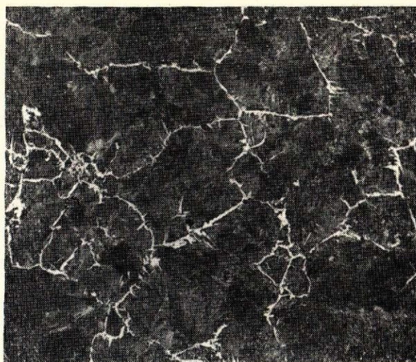
125. att. Asotes caursitņa (123. attēls — 2) griezuma mikrostruktūra; palielin. 100 ×.
