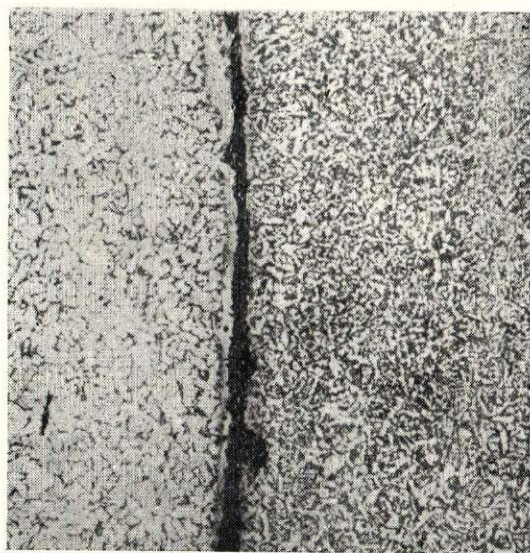
33. att. Ķentes naža (31. attēls — 1) asmens virsotnes griezuma mikrostruktūra; palielin. 100 x.
