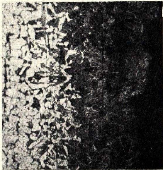
55. att. Vilkmuižas ezera garākā zobena fragmenta (52. attēls — 4) asmens cementēšanas vietas mikrostruktūra; palielin. 100×.
