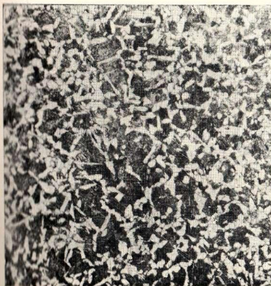
47. att. Zvidru zo- bena (45. attēls) roktura daļas grie- zuma a—a mikro- struktūra; palielin. 100×
