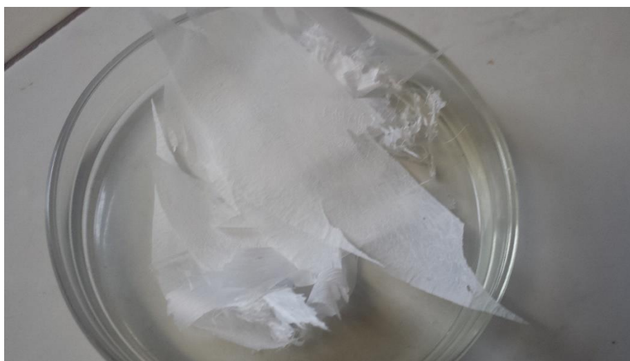
3.7. att. Ar mikroviļņu sintēzes metodi iegūtais TiO 2 nanošķiedru pārklājums novietots uz Petri plates (Petri plates diametrs 90 mm).
