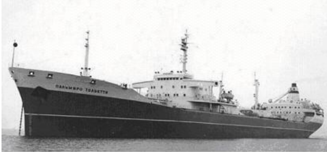
Рис. 5. «Пальмиро Тольяти» - один из 23 танкеров проекта «София» (1965): водоизмещение 62 000 т, длина судна 230 м, ширина 31 м, осадка 10,8 м, скорость хода 32 км/ч.
