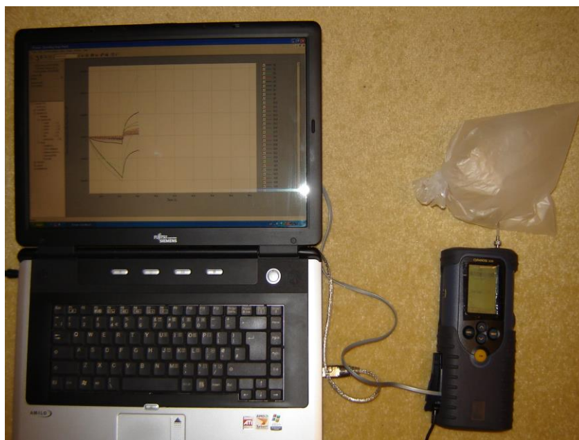
15.attēls. Datu analīzes process ar 32-sensoru mākslīgās ožas ierīci “Cyranose 320” (Smith’s Detection Ltd, Pasadena, ASV) un datorprogrammu „PCNose”
