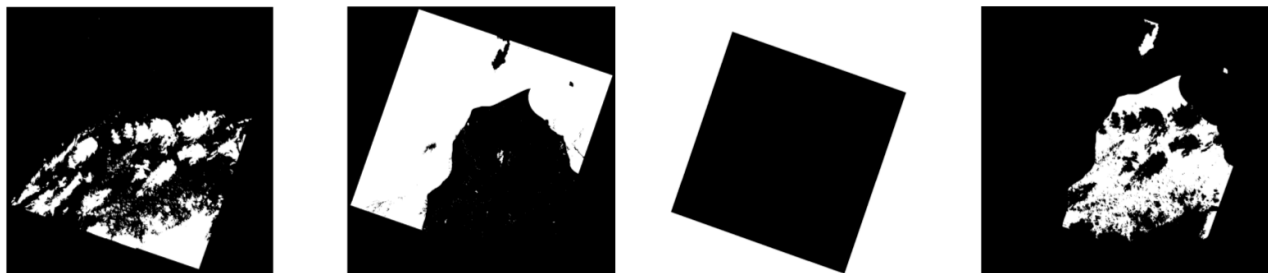
Att. 4.10. No kreisās puses: a) mākoņu un mākoņu ēnu maska C , b) ūdens teritoriju maska W , c) datu nesaturošo pikseļu maska, d) attēla derīgo daļu maska.
