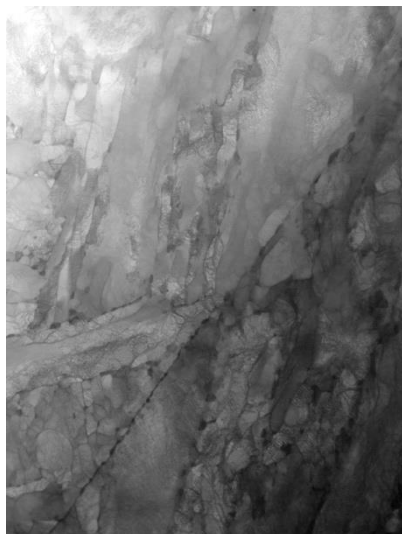
1.2. attēls. Martensīta tērauda TEM attēls (12.1 \mu m ).
