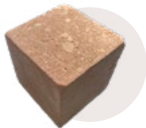
Sārtā apdares dolomīta kubiņš izzāģēts no izpētes urbuma serdes analīžu veikšanai. Valsts nozīmes dolomīta atradne Kranciems .
