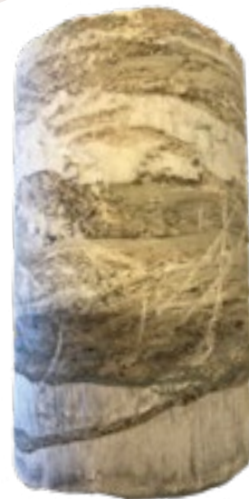
Ģipšakmens atradnes Zvejnieki Mālpils pagastā ģeoloģiskās izpētes urbumu serde ar šķiedru ģipsi.
