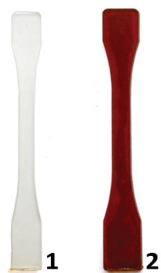
9. attēls. Cietinātie komerciālie epoksīdsveķi Araldite LY 1564: sākotnējais paraugs (1) un paraugs, kurā 10% glicidilēta BPA aizvietoti ar lignīna epoksīdu (2)
