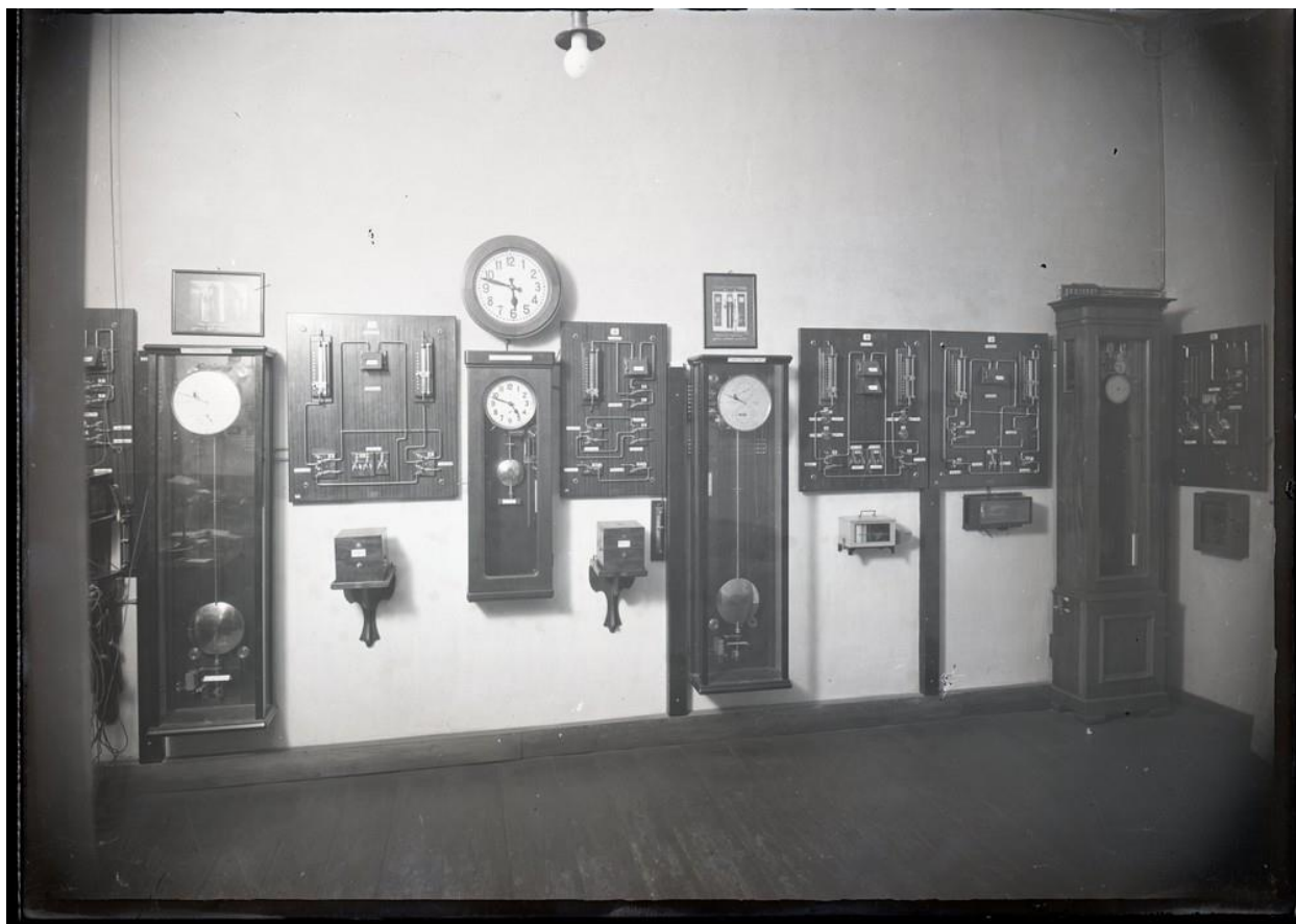
22. attēls. Pulksteņu istaba ar slēgtāfelēm. No kreisās: pulksteņi Riefler 435, Siemens , virs tā “minūšu lēcējs”, Riefler 402, Wagner . Lejā: divi hronometri, termogrāfs, “pīkstenis”. Augšā: 1924. gada pulksteņu pagraba fotogrāfijas. 1925. – 1927. (?) gads.
