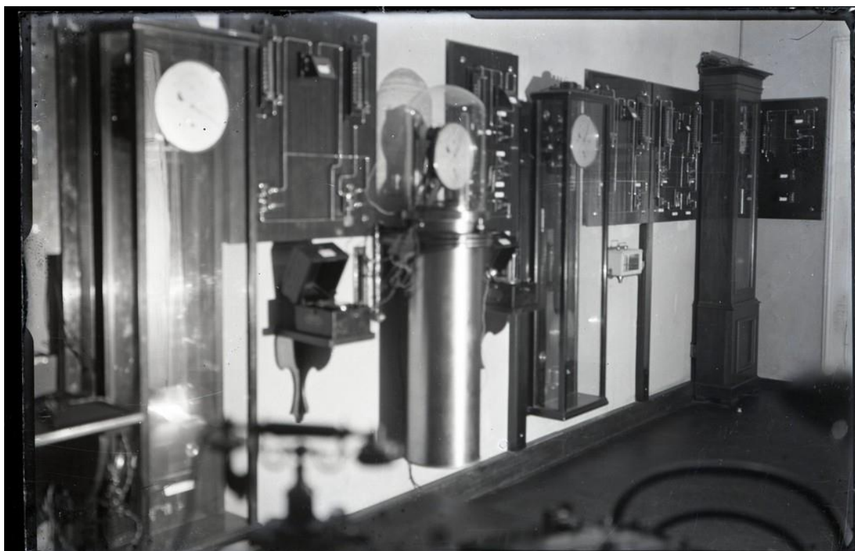
13. attēls. Pulksteņu istabā. Slēgtāfeles, divi hronometri. No kreisās: pulksteņi Riefler 435 un Riefler 403. 1923. gada janvāris – 1925. gada janvāris.
