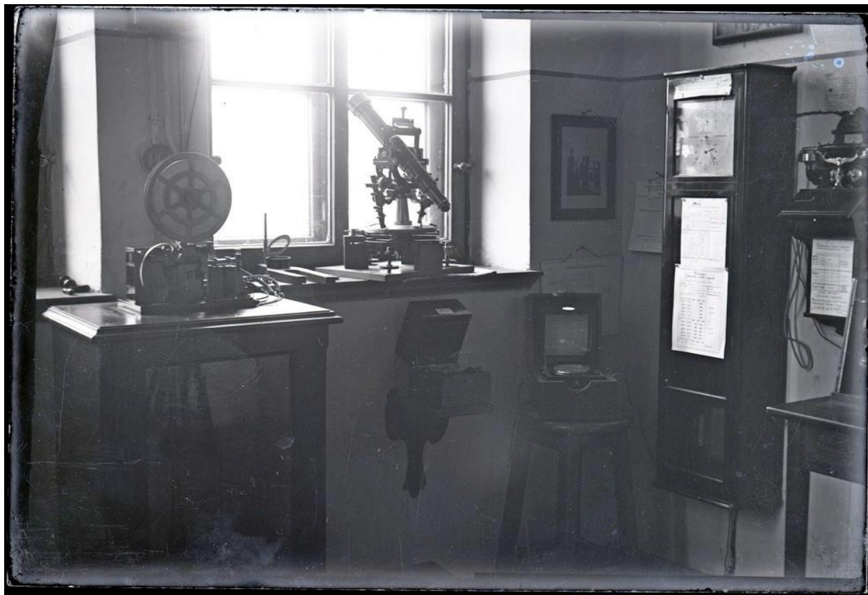
5. attēls. Iekārtas 402. telpā. No kreisās: Fuess hronogrāfs, universālinstruments, divi hronometri, Dencker pulkstenis. Pirms 1922. gada (?).
