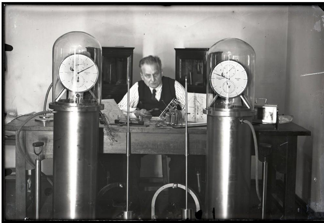
6. attēls. E. Lips montē galvenos Riefler pulksteņus. No kreisās Riefler Nr. 403 un Nr. 457. Aizmugurē Knoblich un Dencker pulksteņi. Pa labi uz galda termogrāfs. 1924. gada rudens.
