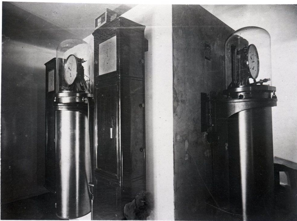
18. attēls. Pulksteņu pagrabā. No kreisās: pulksteņi Dencker , Riefler 403, Knoblich , Riefler 457. Augšā – termogrāfs. Fotografējis E. Lips. 1924. gada decembris
