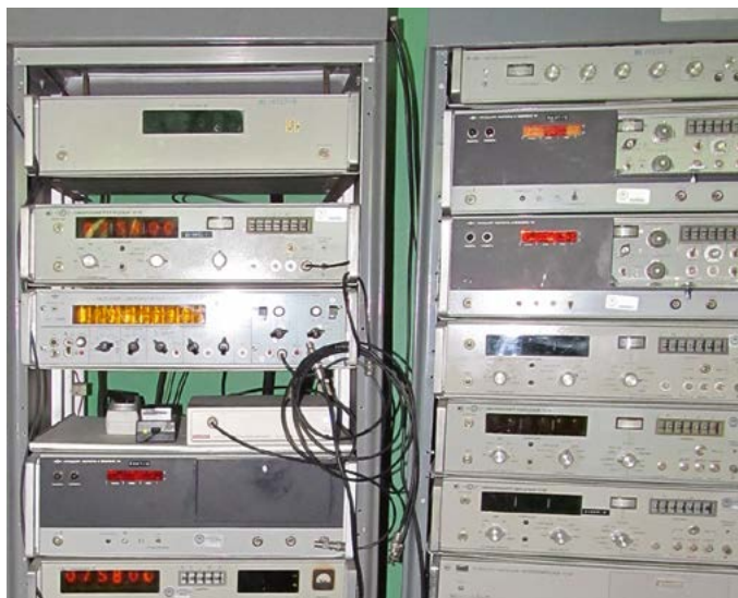
Precīzā laika aparātūra 21. gadsimta sākumā. Redzams standarts Č1-74 ar melnu priekšējo paneli
