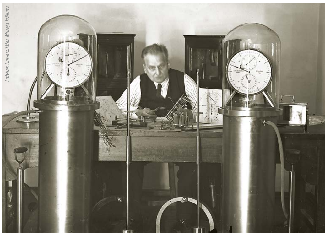
Hronometrists Ernsts Lips montē Riefler galvenos pulksteņus
