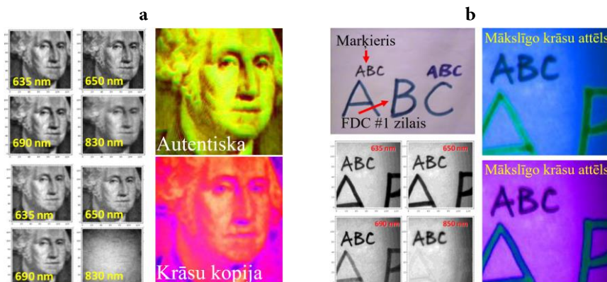
1.6. attēls. Spektrālo attēlu piemēri, kuros parādās izteiktas atšķirības. ASV dolāra autentiska banknote un tās spektrālie attēli (a, augšā), ASV dolāra krāsu kopija un tās spektrālie attēli (a, apakšā), tinšu paraugu analīze (b) [44]
