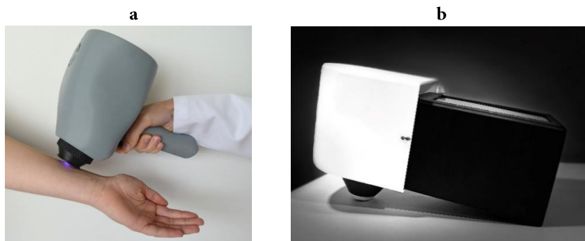
2.6. attēls. Četru lāzerlīniju apgaismojuma ierīces vizuālais izskats ar vienu (a) un divām kamerām (b) [P6, K3]
