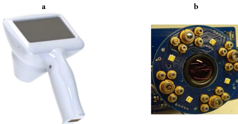
1.9. attēls. Piecu lāzerlīniju attēlošanas ierīces ārējais dizains (a) un lāzerdiožu gredzens (b) [50], [P5]
