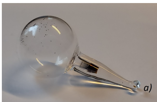
2.1. att. Arsēna ABL (a) un ierosmes ģenerators ar arsēna ABL (b).
