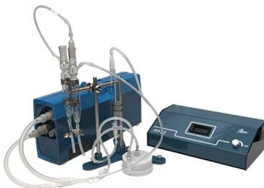
2.12. att. Dzīvsudraba analizators RA-915M ar palīgierīci RP-92 [107].
