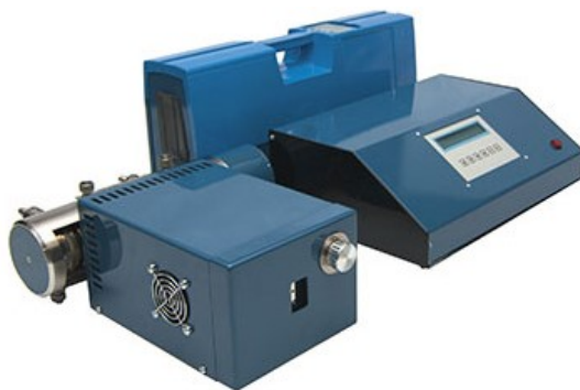
2.14. att. Dzīvsudraba analizators RA–915M ar palīgierīci PIRO–915+ [107].
