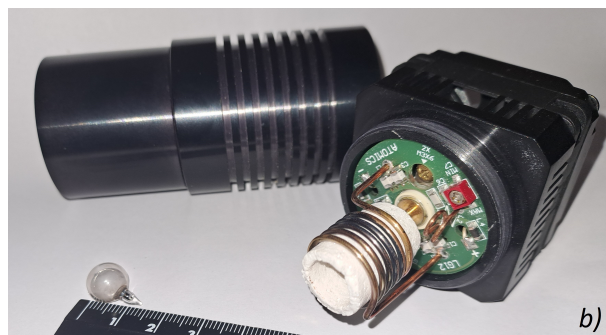
2.1. att. Arsēna ABL (a) un ierosmes ģenerators ar arsēna ABL (b).
