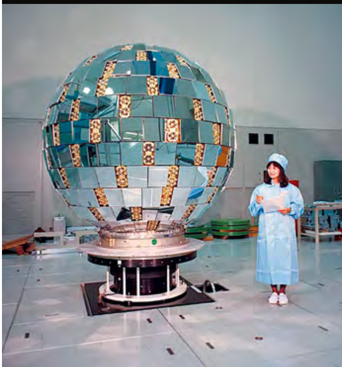
Japāņu ģeodēziskais pavadoņs Ajisai . Redzami plakani spoguļi un ieaļāji lāzeratstarotāji
