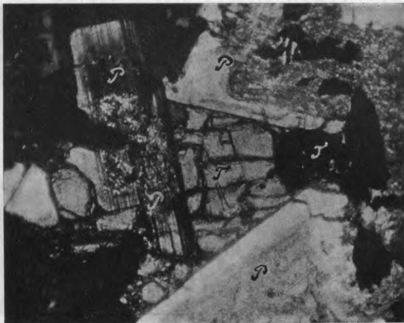
Fig. 45. Andeutung an die ophitische Struktur in einem Einschluß. P — Plagioklas, T — Titanit. Nik. +. Vergr. 85X.
