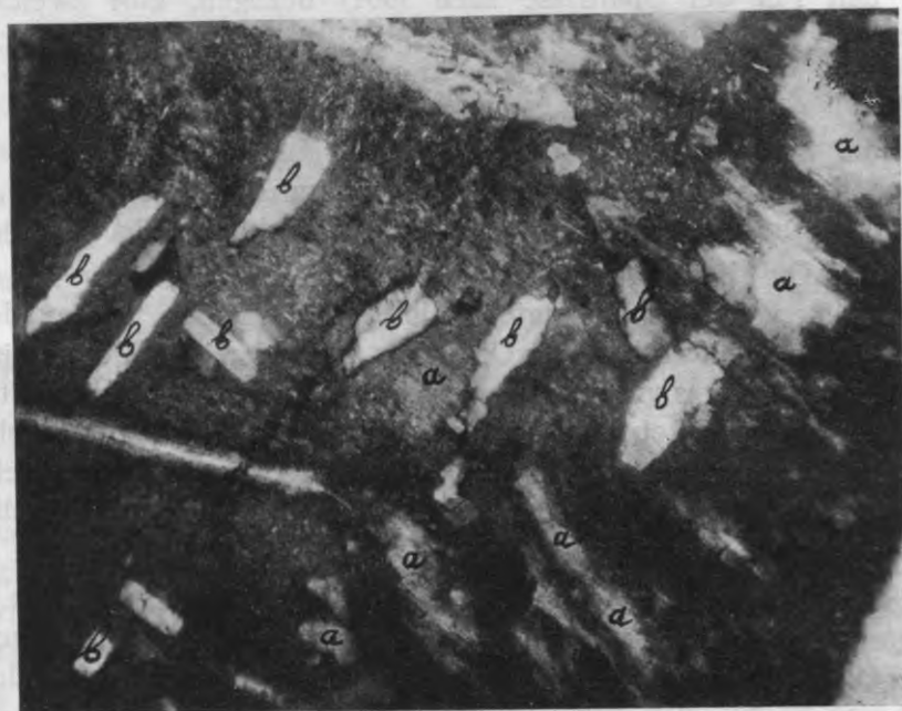
Fig. 51. Stelle eines Orthoklaskornes, bei 85-facher Vergr., die nach dem Perthitgesetz orientierten, unbestimmt begrenzten Albitflecke (a) und die scharf begrenzten Plagioklasleisten (b) gleichzeitig zeigend. Nik. +.
