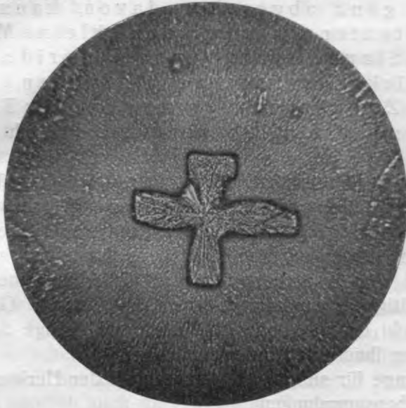
Fig. 61. Skelettartig ausgebildeter Steinsalzkrystall. Die flachen Abstumpfungen entsprechen den Würfelflächen. Nur Polarisator. Vergr. 75 \times .
