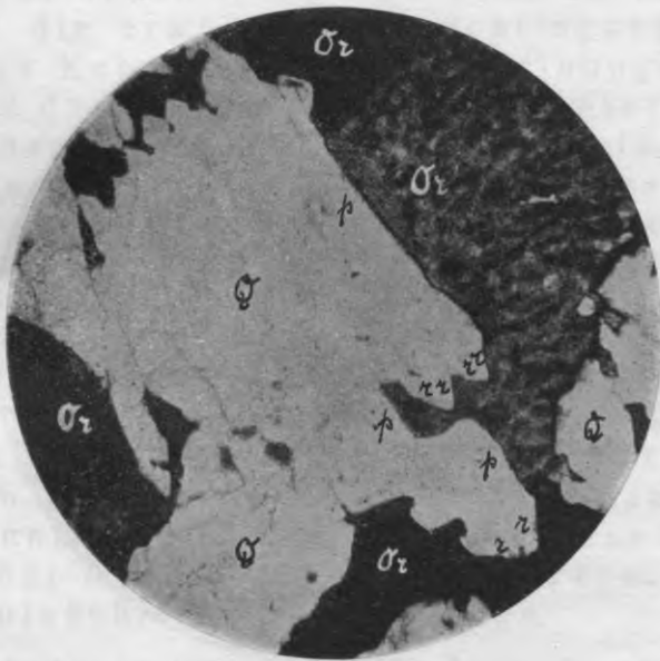
Fig. 56. Skelettartiges Weiterwachsen eines zum Teil kristallautomorphen Quarzkornes. Q — Quarz, Or — Orthoklas, r — (10\bar{1}1) bzw. (10\bar{1}\bar{1}) , p — (10\bar{1}0) . Nik. +. Vergr. 30\times .
